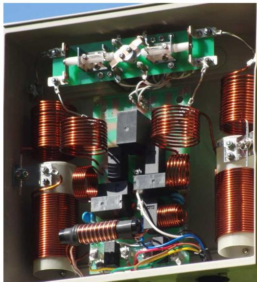
モータ式高耐圧スイッチを搭載した リレコントロール式ハイパワー型ATU
